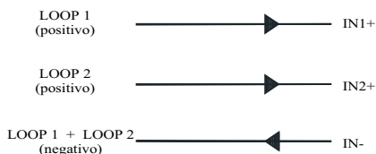
FIG. 6 LOOP 4...20 mA (alimentato)
